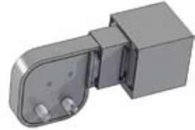
Fig. | 1 Parte frontal del chasis despiece con soporte de motor vista inferior
